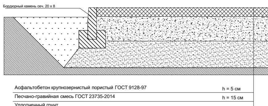
Конструкция асфальтобетонного покрытия
